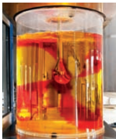
I mixer a getto rotante Iso-Mix iniettano il fluido, il gas o le polveri tramite ugelli rotanti senza provocare la rotazione in batch.
